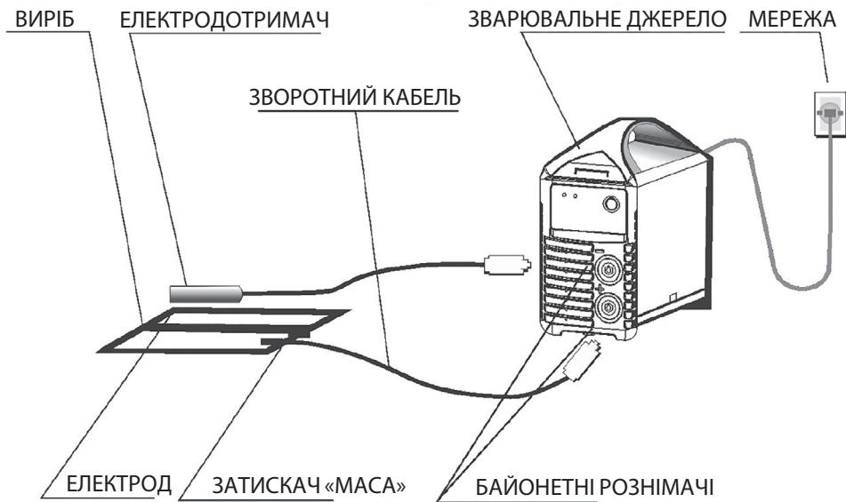
Малюнок 5. Схема підключення обладнання для MMA-зварювання
