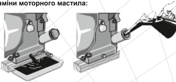
Рисунок 11. Заміна мастила двигуна виробу.
