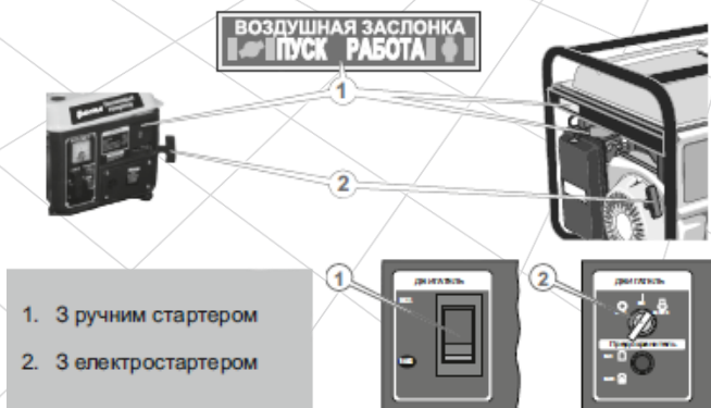
Рисунок 9. Органи керування виробу під час запуску.
