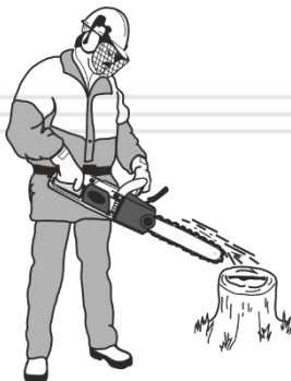
Рисунок 5. Схема перевірки системи подачі мастила.
