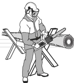
Рисунок 14. Розпилювання колоди з використанням козлових опор.
