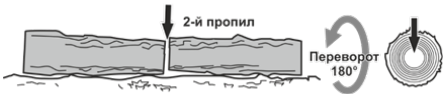
Рисунок 15. Схема остаточного розпилу колоди з протилежного боку.
